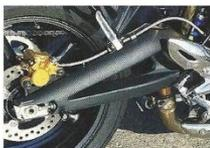
Aus einem Guss: Solide Aluschwinge der Triumph Street Triple
