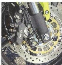
Brems-Triple: Honda bestückt das ABS mit Dreikolben-Sätteln
