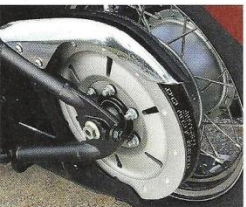
Riemen-Rausch: Kawasaki setzt auf wartungsarme Antriebstechnik
