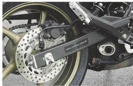
Gut & günstig: Zierliche Stahlschwinge und einfache Kettenspanner
