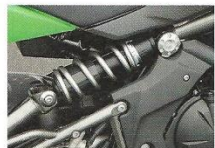
Unübersichtbar: Rechtsseitiges, gut zugängliches Federbein
