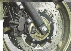
Typisch Yamaha: ABS mit verdecktem Impulsring
