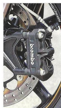
Eine Doppelscheibe ist völlig überflüssig: Mit den Vierkolben-Bremsos steht die Kati wie angenagelt
