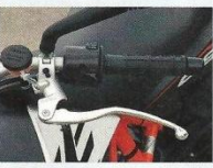
Edelste Fördertechnik: Sogar der Kupplungshebel ist mit einer Radialpumpe für die Hydraulik ausgestattet
