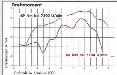
Kopf an Kopf: Beim maximalen Drehmoment kann sich die Shiver nicht sichtbar absetzen
