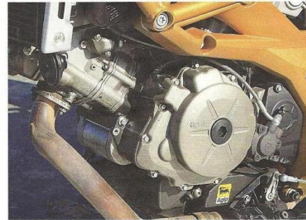
Hydro-Power: Wassergekühlter Hightech-V2 aus Noale
