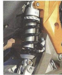
Simple Sache: Einfaches Solo-Federbein mit guter Funktion
