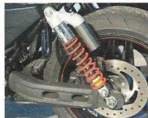
Farbtpuffer: Einstellbare Stereo-Federbeine mit Ausgleichsbehälter
