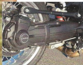
Klassisches vom Comer See: Der Kardantrieb gehört zur typischen Guzzi-Ausstattung
