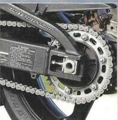
Leichtbau: Filigraner Oberzug an der Hondaschwinge
