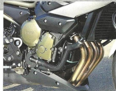
Ich war mal ein Supersportler: Mit einem neuen Zylinderkopf kaschiert Yamaha die Drehmomentdelle der FZ6-Baureihe im mittleren Bereich
